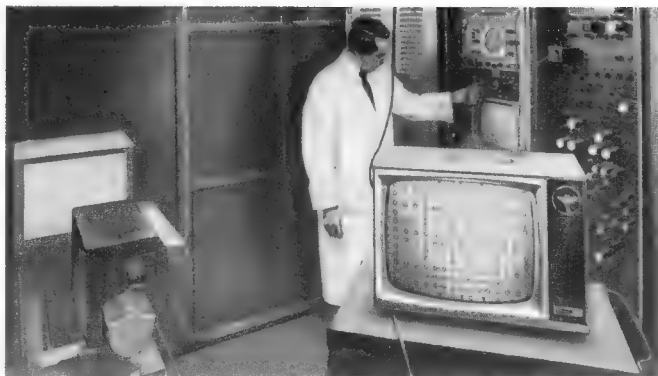
Bild 1. Ein „tragbarer“ Fernsehempfänger (Gewicht 24 kg) wird mit Hilfe eines Laborsenders auf Bildqualität untersucht
